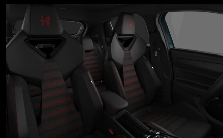
Sedadla Sabelt Corsa v kombinaci techno kůže a Alcantary (Junior Q4 824, Speciale 878)
